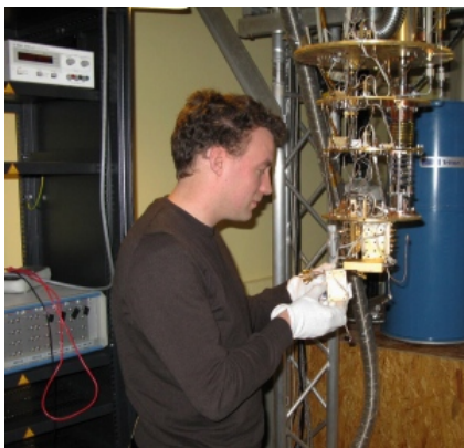
یک پژوهشگر در PTB، در برانشویگ آلمان، یک تراشه نیمه‌رسانا را که دارای پمپ تک الکترونی است، کار می‌گذارد
